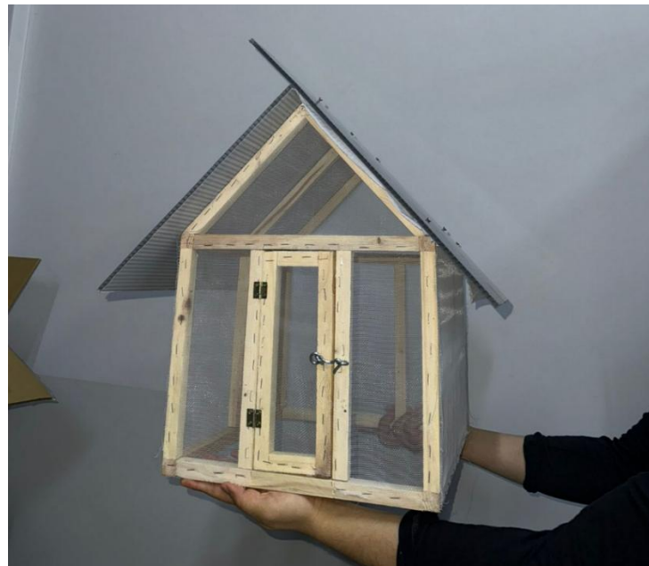
Figura 5: Prototipo de invernadero IoT a pequeña escala. Fuente: Elaboración propia.
