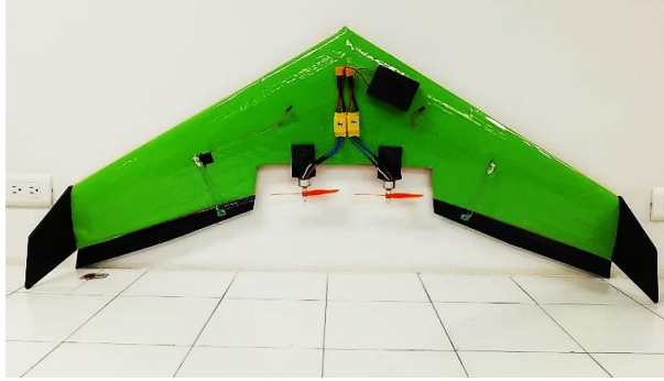
Figura 14: UAV ala Zagi con el circuito electrónico. Fuente: Elaboración propia.
