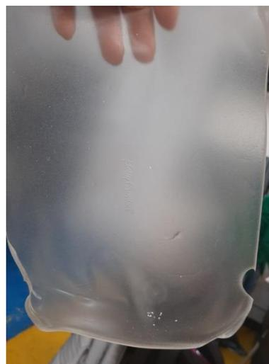
Figura 5: Imágenes fotográficas de película termoplástica de formulación BPGk-5%, contenido 5% de arcilla. Fuente: Elaboración propia.
