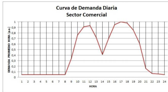
Figura 3: Curva de demanda diaria sector comercial. Fuente: Electrificadora de Santander Grupo EPM.
