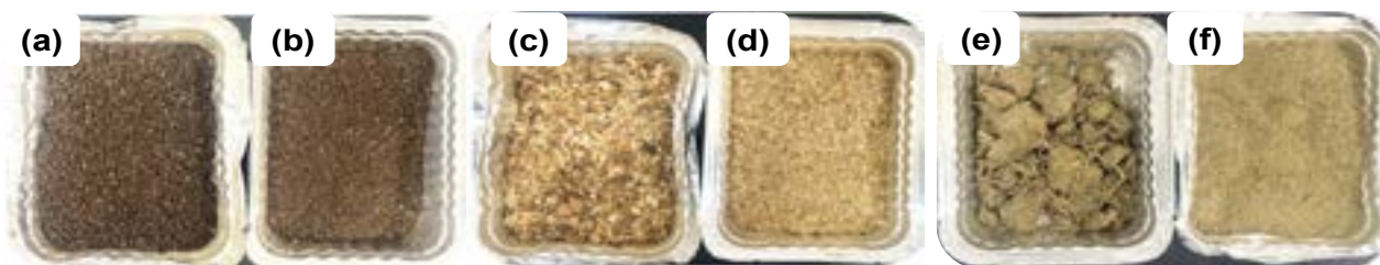
Figura 1. Características macroscópicas de las diferentes muestras de la biomasa residual. Muestras sin moler: Cáscara de palma (a), cisco de café (c) y contenido ruminal bovino crudos (e). Muestras molidas y tamizadas: cáscara de palma (b), cisco de café (d) y contenido ruminal bovino secos(f).
